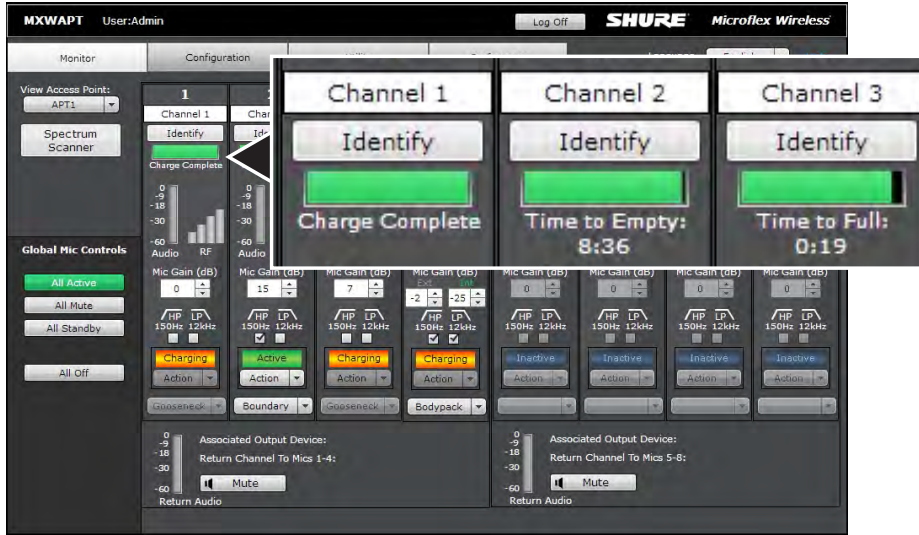
Monitoreo del estado de carga de la batería
