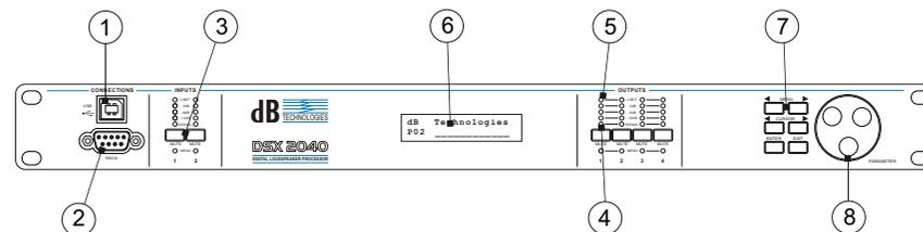
1. USB - Connettore standard USB tipo B. Prima dell'uso installare i driver dal CD con il software fornito.
