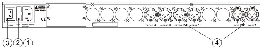
1. Alimentazione principale - Presa IEC standard . Con l'apparato viene fornito il cavo di alimentazione. La tensione di ingresso è 90-240VAC, 50-60Hz.
